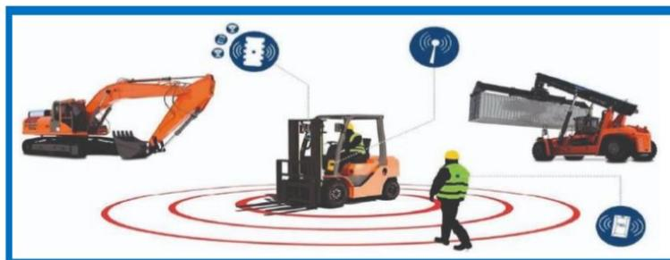
El sistema consistiría en un tipo de baliza o señalizador que capte la presencia de un vehículo, el cual, a través de un sistema de alarmas conectado con el trabajador, avise de la presencia del vehículo.
